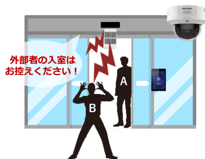
顔認証カメラで認証されていない 人物Bを検知し、スピーカーから 警告を出します。
