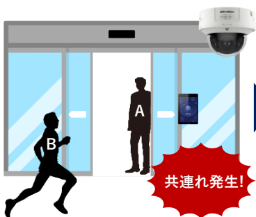
ドアがまだ開いたままの状態で、 外部者Bは認証を行わずに ドアを通過します。
